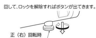
押して、回して下さい。自動的にロックします。
